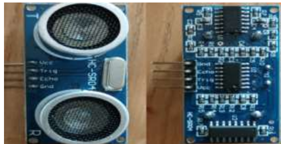
Fig. 1 HC-SR04 Ultrasonic Module
